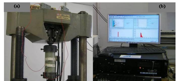
Montage de traction de tubes avec capteur EA
